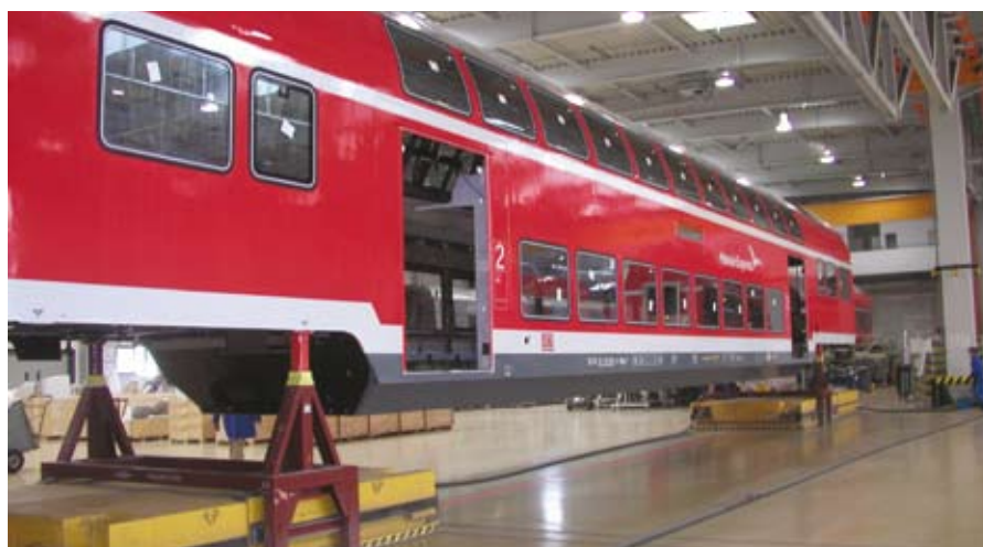
Endmontage von Doppelstockwaggons
