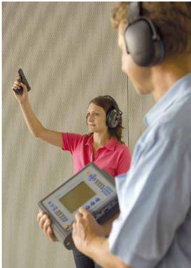
Ermittlung der äquivalenten Schallabsorption einer Halle durch Messung der Nachhallzeit
