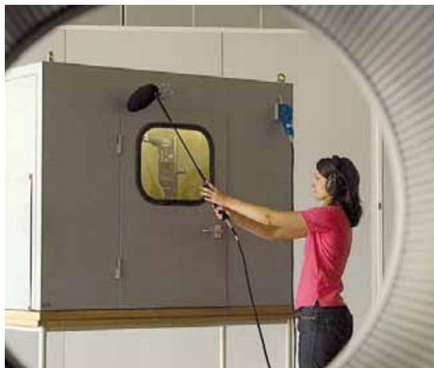
Überprüfung der Dichtigkeit einer Schallschutzkabine mittels Schallintensitätsmesssonde
