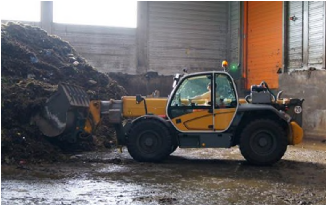
Abb. 22 Innerbetrieblicher Transport von Abfällen mit einem schutzbelüfteten Teleskop-Radlader
