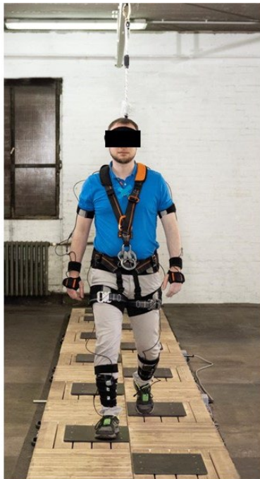
Abbildung 20: Stolper-, Rutsch- und Fehltreten Parcours (SRF-Parcours) mit dem an der Decke montierten Schienensystem der Firma Skylotech mit einem Beispielproband
