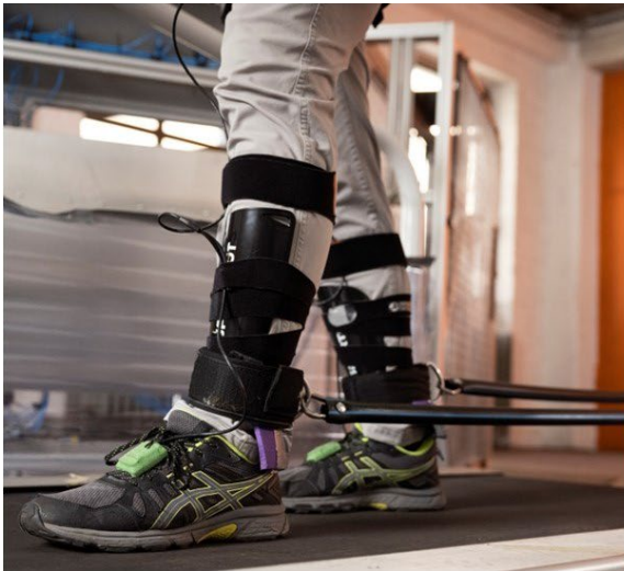
Abbildung 18: Fußmanschetten für die mechanische Perturbation an den Füßen (linke Abbildung) sowie Anschlagpunkte für die mechanische Perturbation an der Hüfte (rechte Abbildung)
