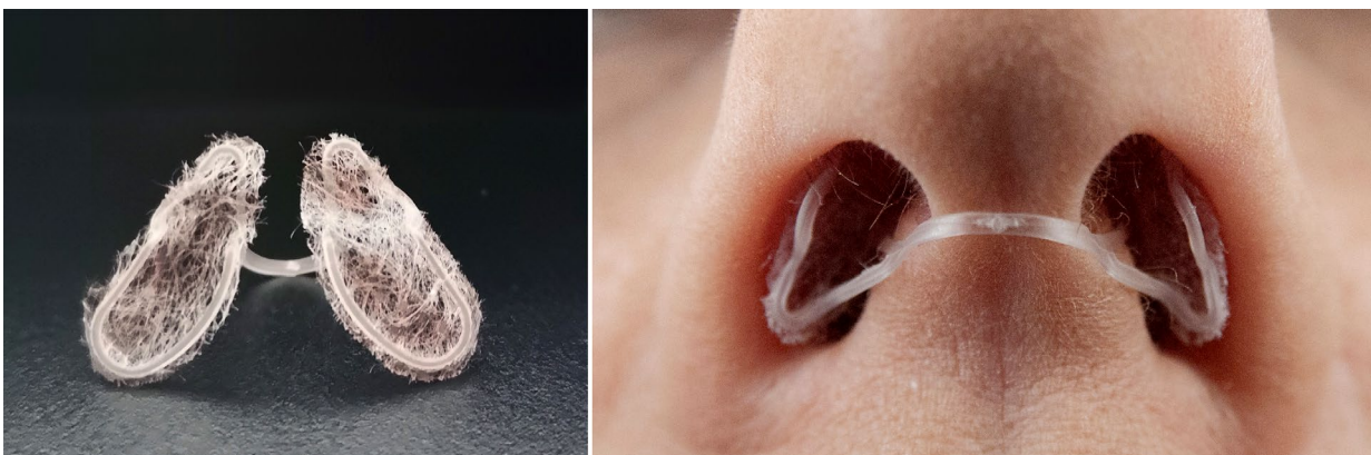
Abb. 1 Nasenfilter zur personenbezogenen Ermittlung der Belastung mit Allergenen
