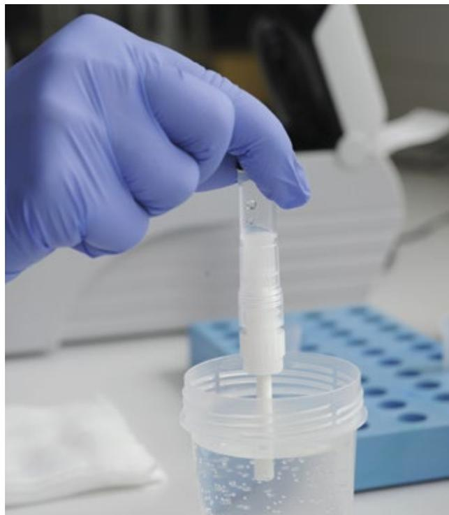
Abb. 1: Der Messstift wird direkt in das zu untersuchende Wasser getaucht und das Messergebnis liegt innerhalb von fünf Minuten vor.
