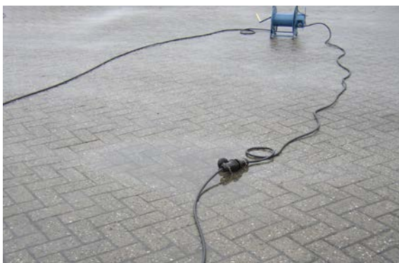
Bild 1: Druckwasserdichte Steckvorrichtung, leicht eingetaucht während eines Ausbildungsdienstes
