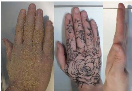
Abb. 3: Einflussfaktoren auf die Erkennung bei einer KI-basierten Handerkennung (Verschmutzung, Tattoo, Handstellung)
