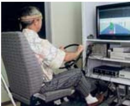
Bild 3: Fahr Simulator im Labor für Ergonomie und angewandte Psychologie
