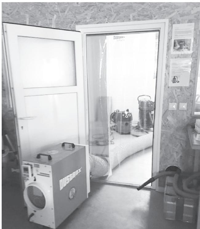
**Bild 7.** Luftreiniger mit Ansaugschlauch. *Quelle: BG BAU, Walter Gunreben*
