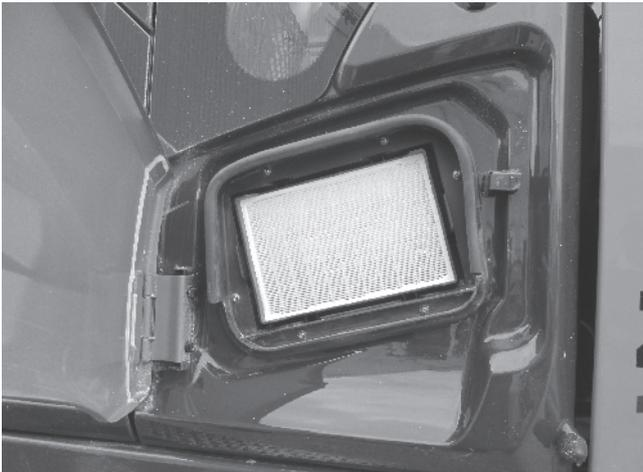
Bild 15. Verbessertes Zuluftfilter.
