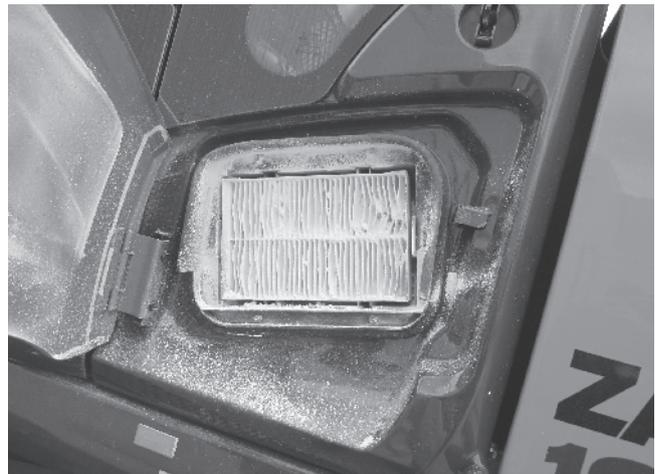
**Bild 13.** Standard-Kabinenzulffilter nach Bestäubung mit Feinkalk.
