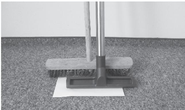
**Bild 9.** „Küchensauggarnitur“ mit 30 cm Breite und Saugrohr mit 32 mm Durchmesser; bei vielen Entstaubern derzeit die Standardausstattung.
