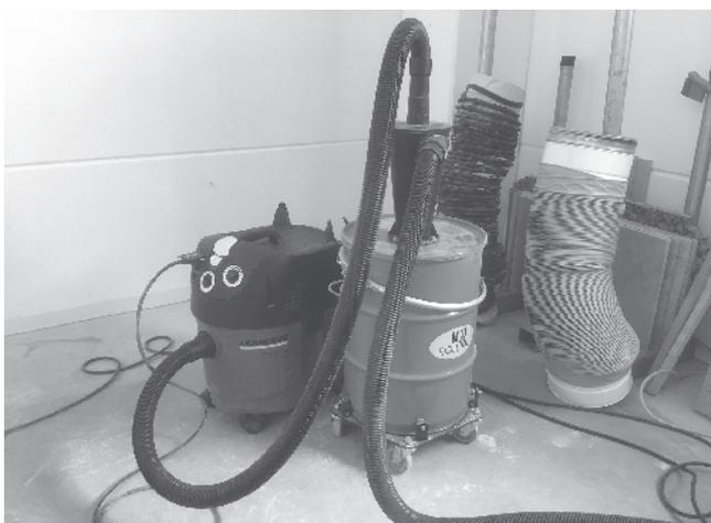
**Bild 4.** Entstauber mit vorgeschaltetem Vorabscheider.
