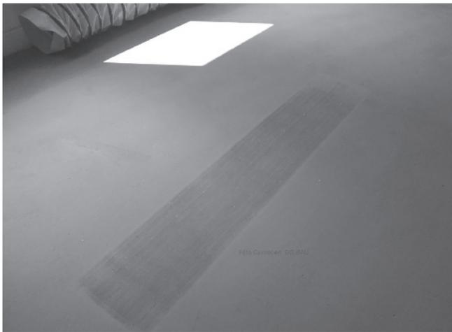
**Bild 12.** Reststaubbelastung des Bodens; mittig wurde ein Streifen zusätzlich mit einem Entstauber abgesaugt.
