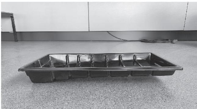
**Bild 2.** Wasserwanne einer mobilen Steinschneidemaschine mit in der Höhe abgestuften Boden zur leichteren Reinigung.
