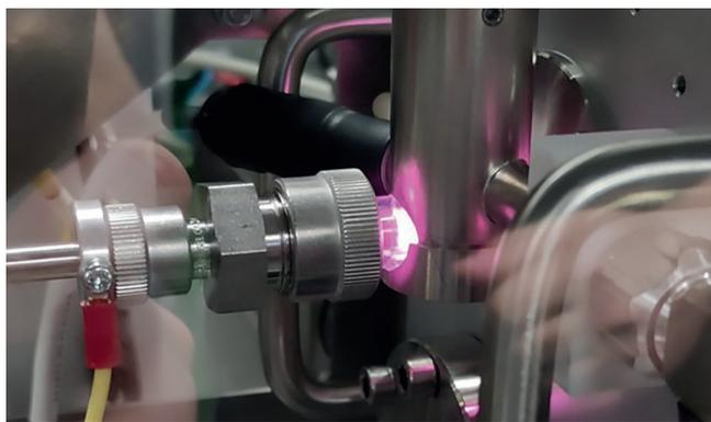
Bild 2 Erzeugtes Mikrowellenplasma in einer SIFT-MS-Ionenquelle. Foto: Autoren
