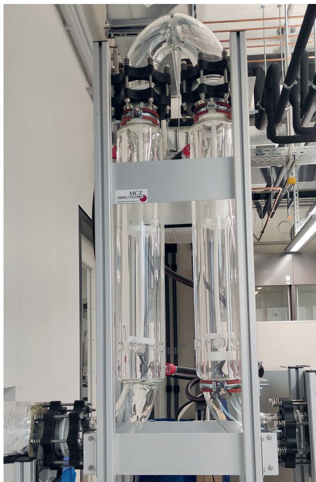
Bild 4 Temperierturm zur Prüfgaskühlung. Quelle: Autoren
