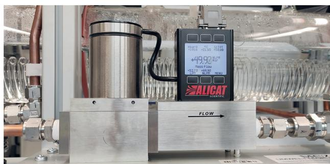
Bild 3 Befeuchtereinheit (oben) und Massendurchflussregelung (unten). Quelle: Autoren
