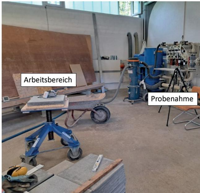
**Bild 13.** Aufbau des Teststandes und Positionierung der FSP-Probenahme für die DoF-Methode. Foto: Autoren
