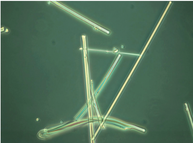
Bild 8. Mineralwolle-Fasern mit Durchmessern von 1 bis 10 µm (Bildbreite 280 µm). Foto: IFA
