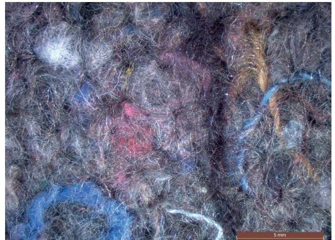
Bild 20. Verfilzte organische Fasern aus unterschiedlichen Geweben (Bildbreite 18 mm, stereomikroskopische Darstellung). Foto: IFA
