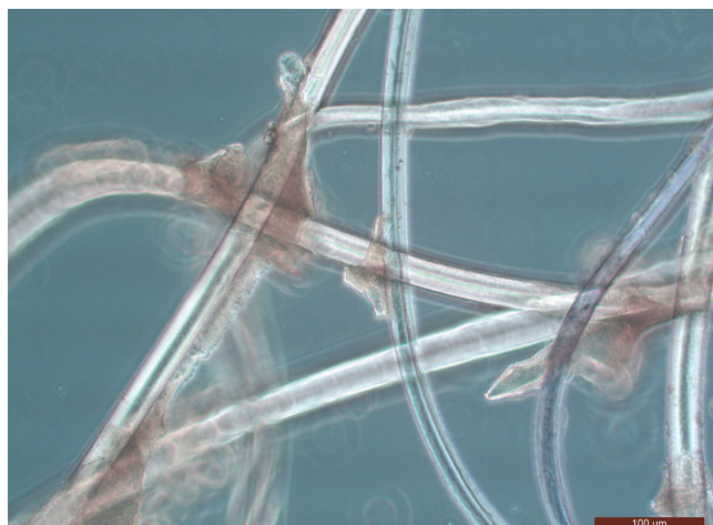
Bild 25. Organische Fasern mit Durchmessern von ca. 23 bis 32 µm, die an mehreren Stellen mit einer Kunstharzmatrix verklebt sind (Bildbreite 650 µm). Foto: IFA
