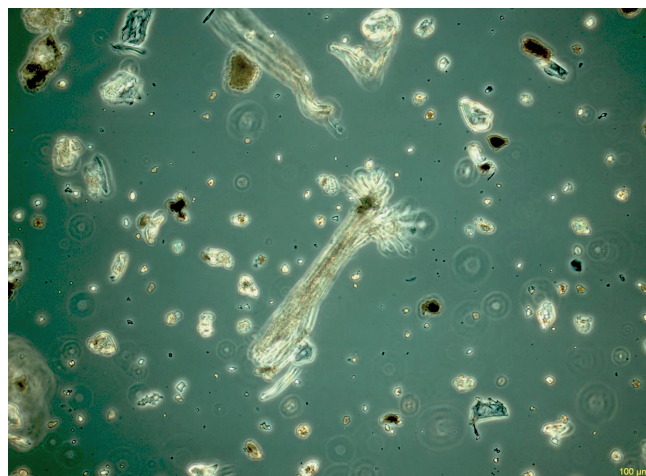
Bild 3. An den Enden aufgespleißtes Stück einer organischen Faser mit ca. 10 bis 20 \mu\text{m} Durchmesser, umgeben von Partikeln mit etwa 5 bis 30 \mu\text{m} Breite (Bildbreite 570 \mu\text{m} ). Foto: IFA
