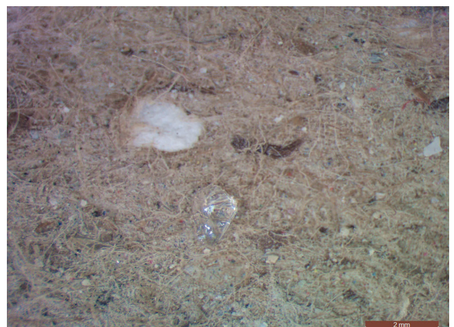
Bild 21. Unterschiedlichste Partikelarten in Zellulosematrix eingearbeitet, mitten im Bild ein Glassplitter mit rund 1 mm Breite (Bildbreite 12 mm, stereomikroskopische Darstellung). Foto: IFA
