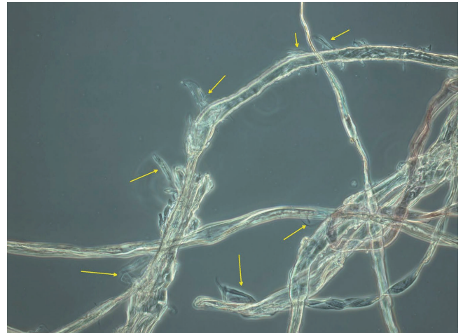
Bild 9. Organische Fasern, zum Teil mit gewundener Struktur und vielen Abspleißungen im Verlauf (Bildbreite 570 µm). Foto: IFA
