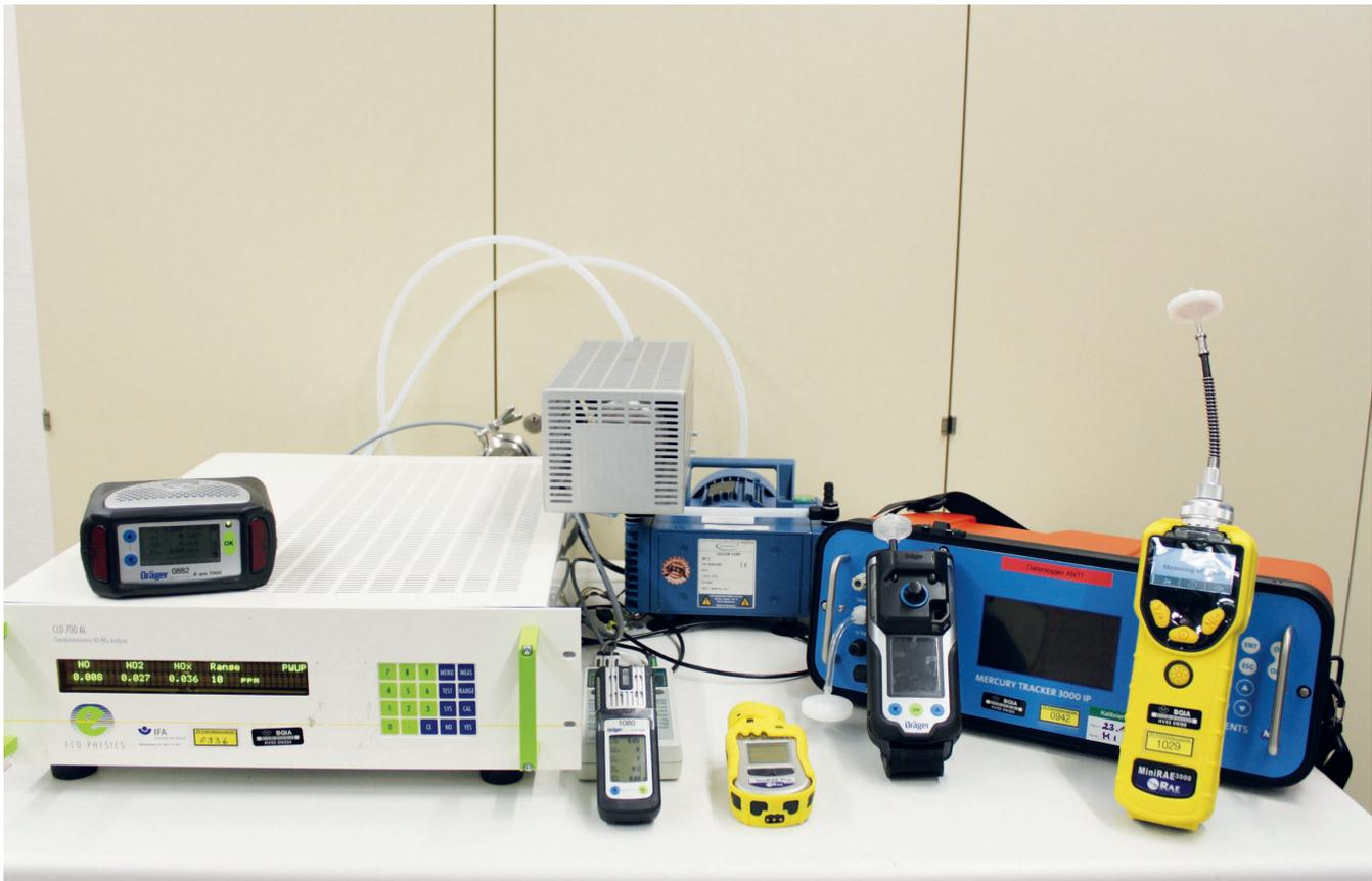
Bild 1 Verschiedene direktanzeigende Gasmess- und Gaswarngeräte. Foto: IFA
