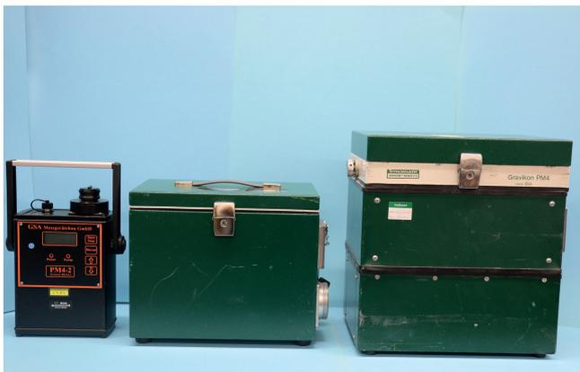
**Bild 2** Weiterentwicklung der Messtechnik: stationäre Probenahmepumpe für die alveolengängige und einatembare Staubfraktion – heute (links) und damals (rechts). Foto: IFA
