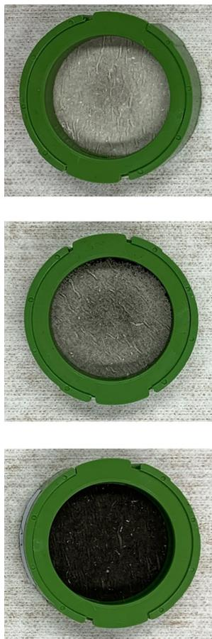
**Bild 3** Messung von  $\rho$ -Toluolsulfonsäure an verschiedenen Arbeitsplätzen einer Gießerei. Foto: IFA
