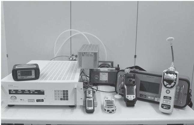
**Bild 1.** Eine Übersicht direktanzeigender Messgeräte. *Quelle: Autoren*
