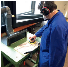
Bild 3: Schleifarbeiten an Fichtenholzplatte (links) und Exzentrerschleifer DEROS 650 (rechts)
