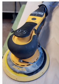
Bild 3: Schleifarbeiten an Fichtenholzplatte (links) und Exzentrerschleifer DEROS 650 (rechts)
