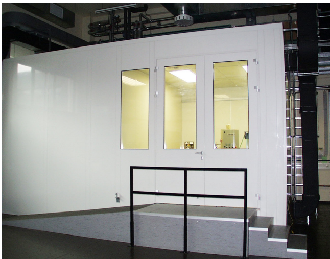
Bild 1 Prüfkabine mit einer Grundfläche von etwa 13 m 2 und einer Raumhöhe von 3 m (links); Raumskizze mit Versuchsanordnung (rechts). Foto/Grafik: Autoren
