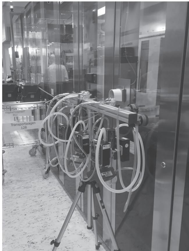
**Bild 4.** Messung im Reinraum neben einer geschlossenen und abgesaugten Produktionsstraße. *Quelle: Autoren*
