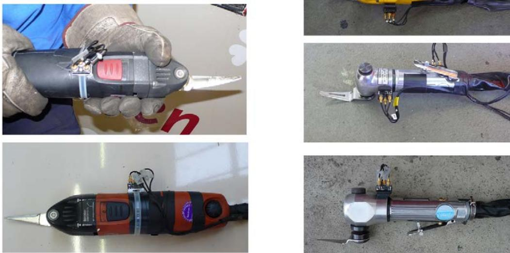
Bild 1: Pneumatische und elektrische Oszillationsmesser
