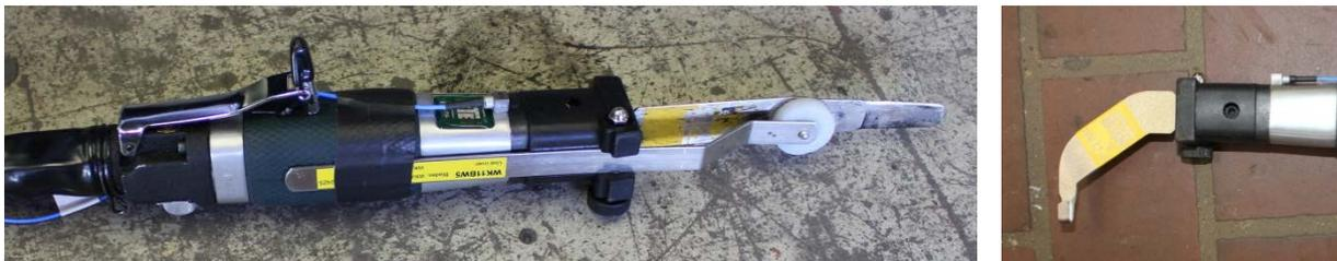
Bild 11: Vibrationsarmes Gerät der Fa. BTB mit verschiedenen Messern
