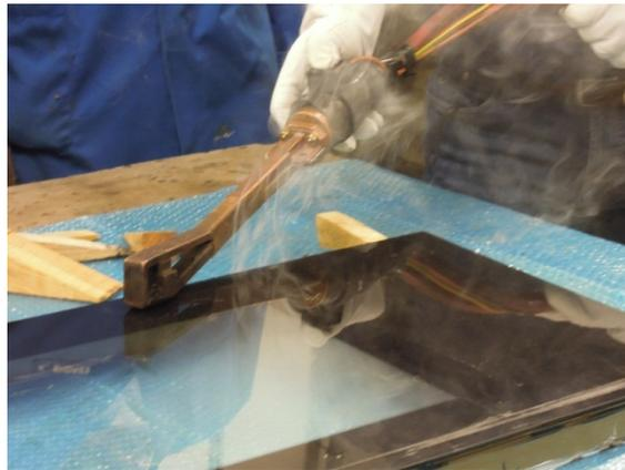
Bild 9: Induktive Erhitzung eines in der Kleberaube liegenden Metallstreifens
