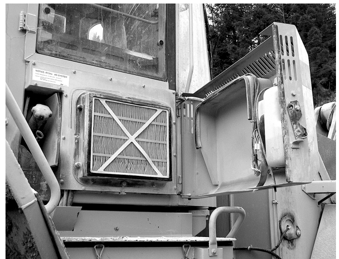
Staubfilterung an einer geschlossenen Kabine eines Radladers.
