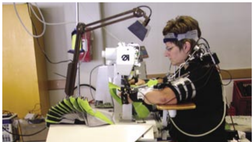
Abbildung 8: Neu entwickelter ergonomischer Näharbeitsplatz, Näherin ausgerüstet mit CUELA-Messsystem.
