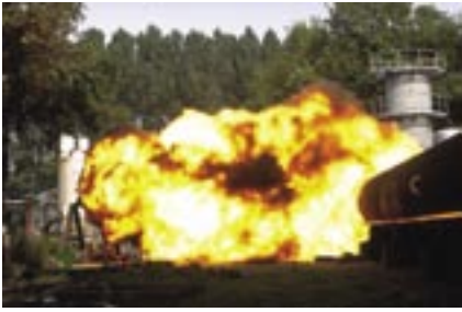
Abbildung 4: Staubexplosion am Ende der 200-m-Strecke der Bergbauversuchsstrecke in Dortmund-Derne (Quelle: EXAM).
