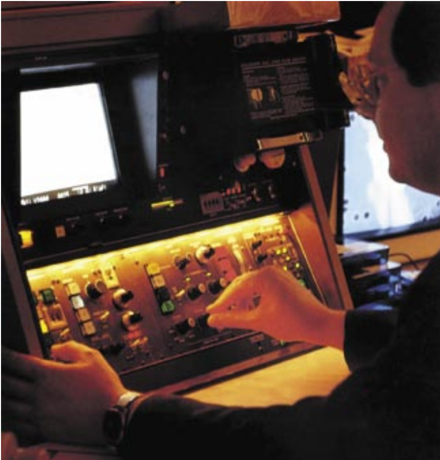
Abbildung 11a: Asbestuntersuchung mit dem Rasterelektronenmikroskop.
