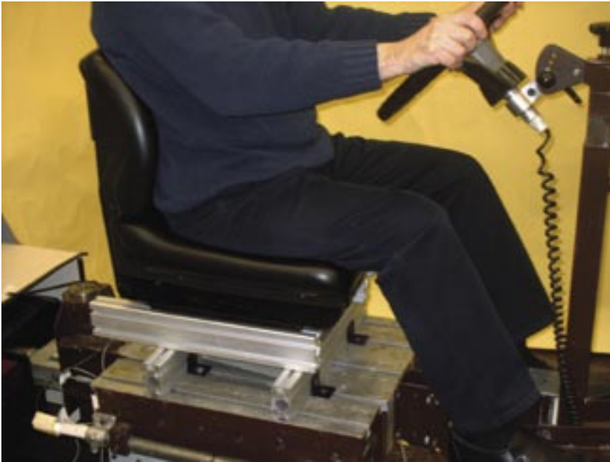
Abbildung 21: Schwingungssimulator im Ganzkörper-Vibrationslabor beim Test von Gabelstapler-Fahrersitzen.
