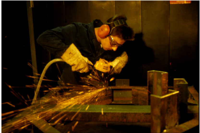
Abbildung: Lärmarme Schleifscheiben reduzieren den Geräuschpegel beim Schleifen
