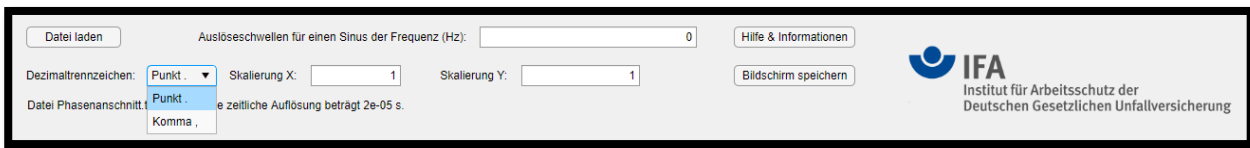
Abbildung 3: Umstellung des Dezimaltrennzeichens für eingelesene Dateien. Daneben kann auch die Skalierung der Zeit (X-Achse) und der magnetischen Flussdichte (Y-Achse) verändert werden.
