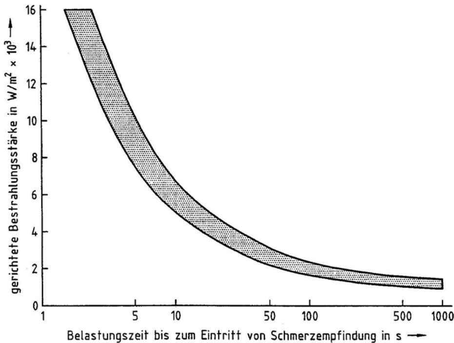
Abb.: Schmerzgrenze der unbedeckten Haut in Abhängigkeit von der Bestrahlungsstärke E und der Expositionszeit t_{exp} . Entnommen der DIN 33403-3, Bild 5
