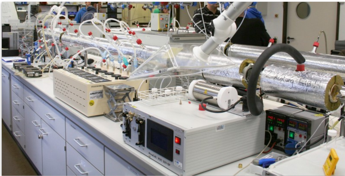
Abbildung 2: Ringversuch an der Prüfgasstrecke im IFA
