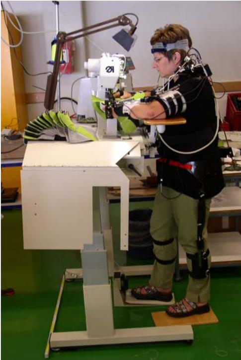
Abbildung: Der neu entwickelte ergonomische Näharbeitsplatz, Näherin ausgerüstet mit CUELA-Messsystem
