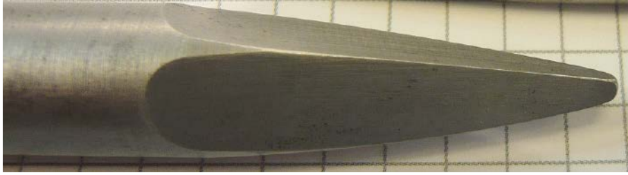
Abb. 4: Der Prüfdorn wurde dem Zahn eines etwa 3–4-jährigen Keilers nachgebaut. Der Radius der Spitze entspricht dem ermittelten Durchschnitt aus Messungen an mehreren Original-Keilerzähnen
