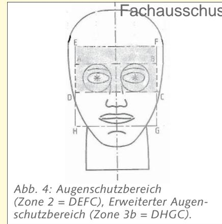
Abb. 4: Augenschutzbereich (Zone 2 = DEFC), Erweiterter Augenschutzbereich (Zone 3b = DHGC).
