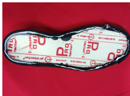
Abb. 1: Sicherheitsschuhe mit durchtrittssicherer Einlage aus textilem Material
