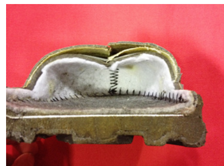
Abb. 2: Querschnitt durch einen Sicherheitsschuhe mit durchtrittssicherer Einlage aus Metall
