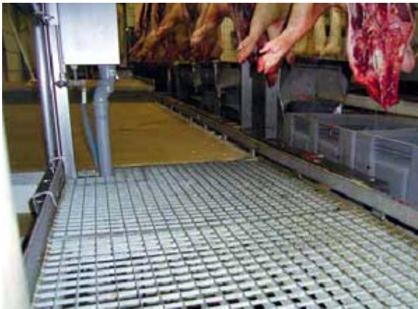
Abb. 17: Arbeitsbühne mit Fußleiste und rutschhemmendem Gitterrost
