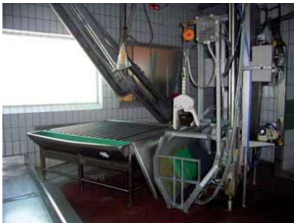
Abb. 12: Rollenband für liegende Entblutung nach Elektro-Betäubung
