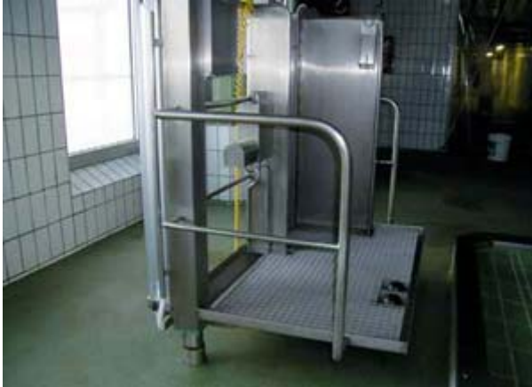
Abb. 17: Arbeitsbühne mit Fußleiste und rutschhemmendem Gitterrost
