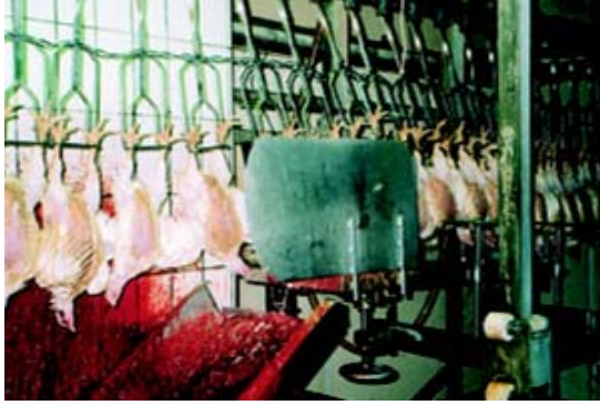
Abb. 23: Manueller Entbluteschnitt bei Puten
