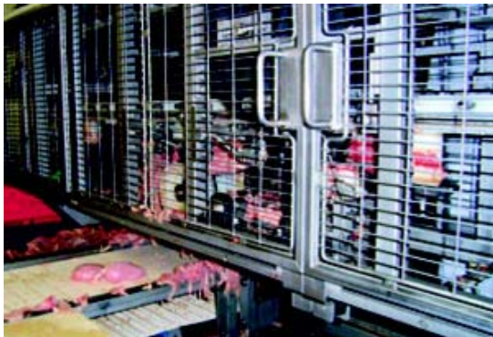
Abb. 6: Trennende bewegliche Schutzeinrichtung mit Griffen
