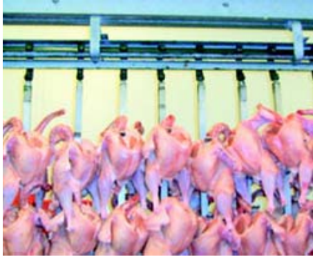
Abb. 4: Putenbehängende Hakenbäume an der Transportbahn
