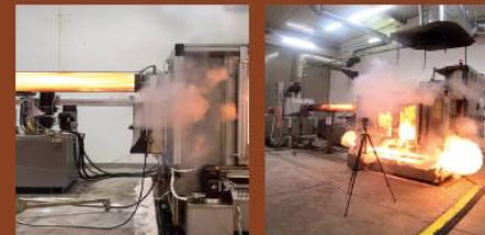
Flammendurchschlag in Absauganlage Brandausbreitung in Hallenbereiche
