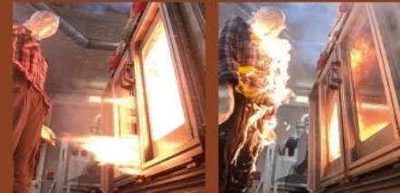
Flammendurchschlag durch Türlabyrinth in Bedienbereich
