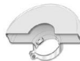
Typ A: Seitlich geschlossene Schutzhaube für das Trennschleifen oder scheibenförmige Bürsten
