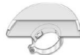
Typ C: Teilweise seitlich geschlossene Schutzhaube für das Schrupp- oder Trennschleifen oder scheibenförmige Bürsten
