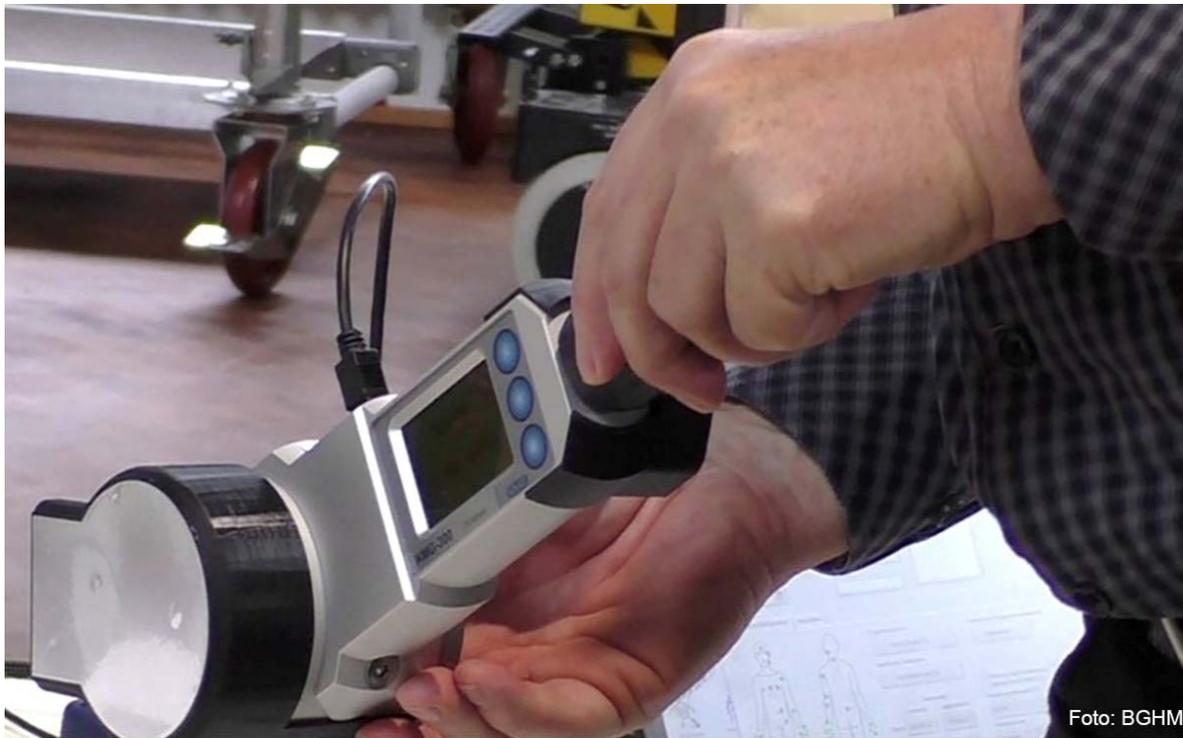
Eine abschließende Messung der biomechanischen Grenzwerte ist erforderlich.
