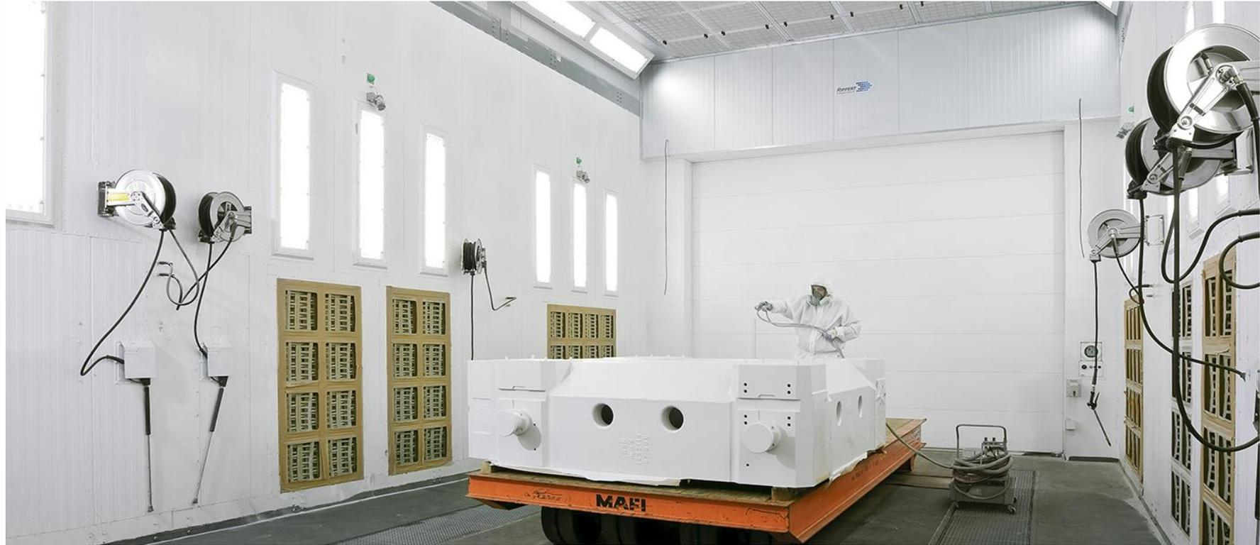
» Lackieranlage für Spritzgießmaschinen
