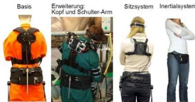
Verschiedene Varianten des CUELA-Messsystems: Basissystem, Erweiterung Kopf und Schulter-Arm-Bereich, Sitzsystem und Inertialsystem
