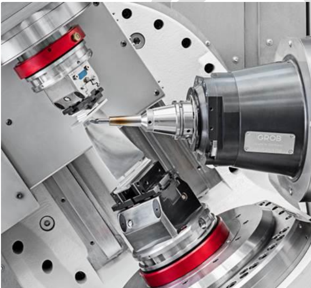
Bild 3: Zwei pneumatische Spannstöcke in CNC-Universal-Bearbeitungszentrum
