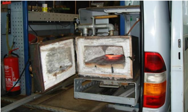
Bild 3: Gasschmiedeofen im Einsatz
