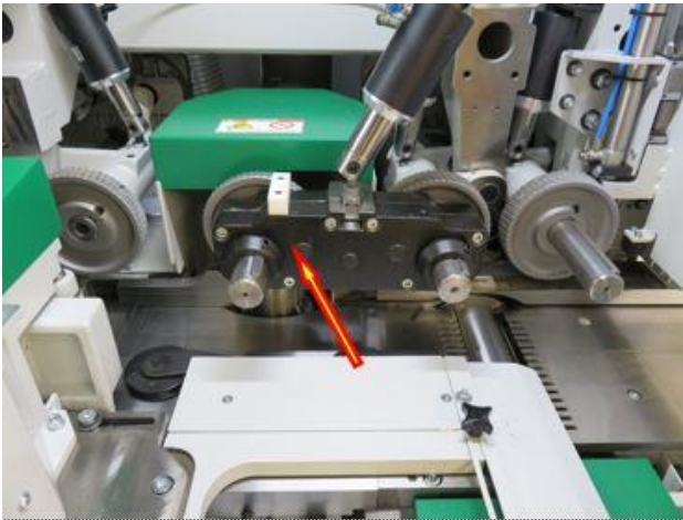
Bild 5: Verdeckung der hinteren Vertikalspindel mit einschwenkbarer Andruckrolle (Pfeil)
