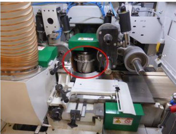
Bild 3: Ungesicherte hintere Vertikalspindel
