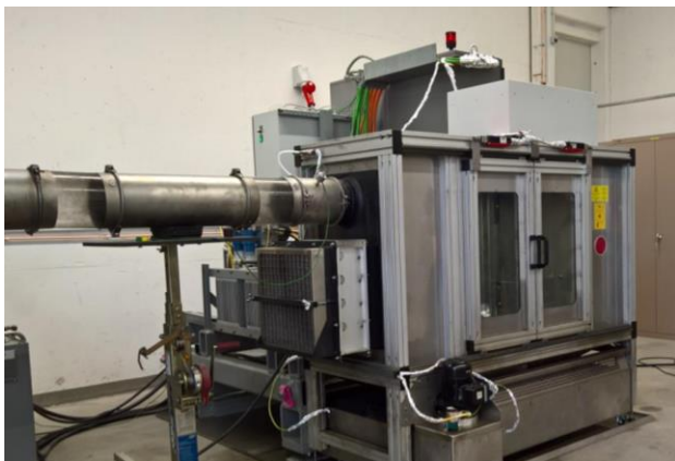
Bild 1: Prüfstand zur Prüfung und Entwicklung von Schutzsystemen gegen Flammenaustritt
