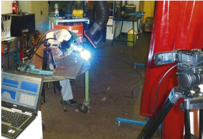
Bild 3 • Untersuchter Schweißvorgang (MAG-Schweißen mit Massivdrahtelektrode).
