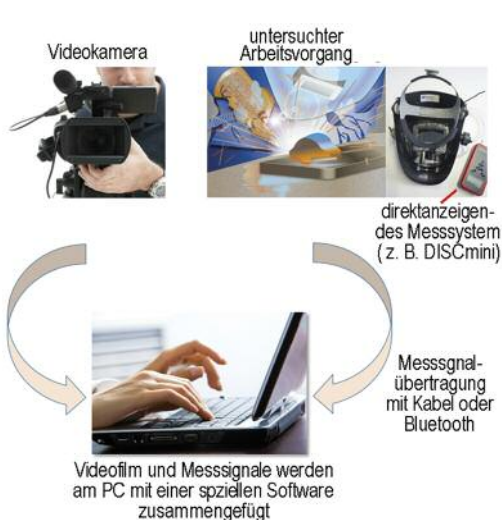
Bild 1 • Funktionsprinzip der PIMEX-Methode.
