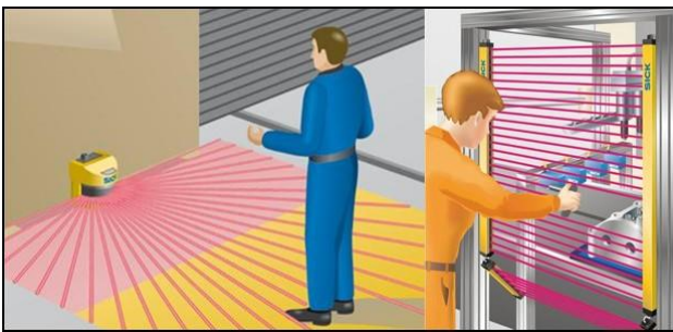
Bild 1: BWS-Beispiele Laserscanner und Lichtvorhang
