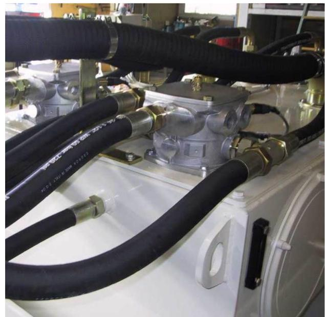
**Bild 5:** Rücklauffilter auf dem Hydrauliktank
