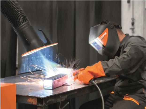
**Bild 2:** Absaugarm mit Düsenplatte
