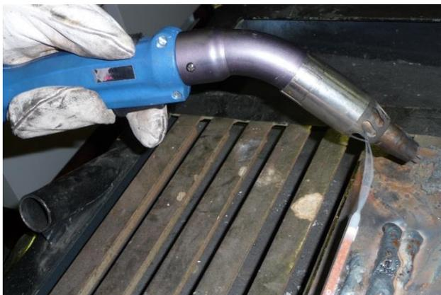
**Bild 1:** Schweißbrenner mit Rauchabsaugung
