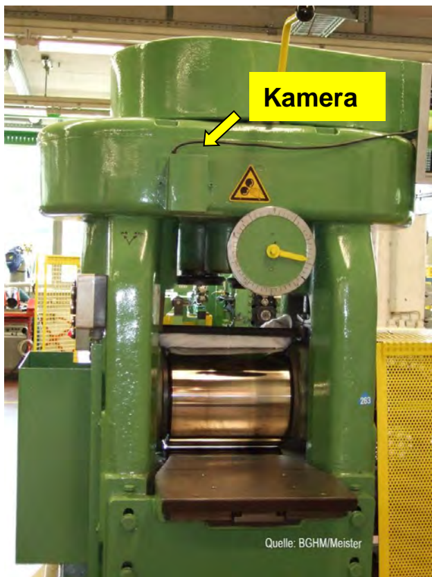
Abb. 14 : Mit einer Kamera ausgerüstetes Walzwerk
