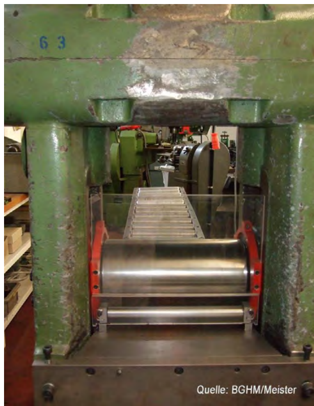
Abb. 9: Blechwalze mit fester Verdeckung und ebenfalls abgesicherter Vorrichtwalze
