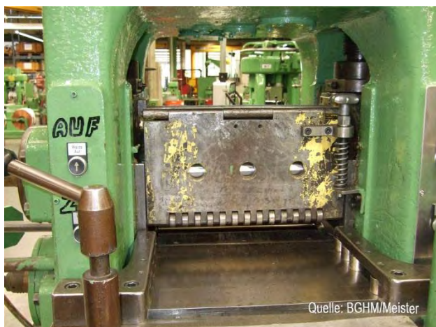
Abb. 12: Beweglicher Handabweiser. Er folgt der Bewegung des aufbiegenden Materials
