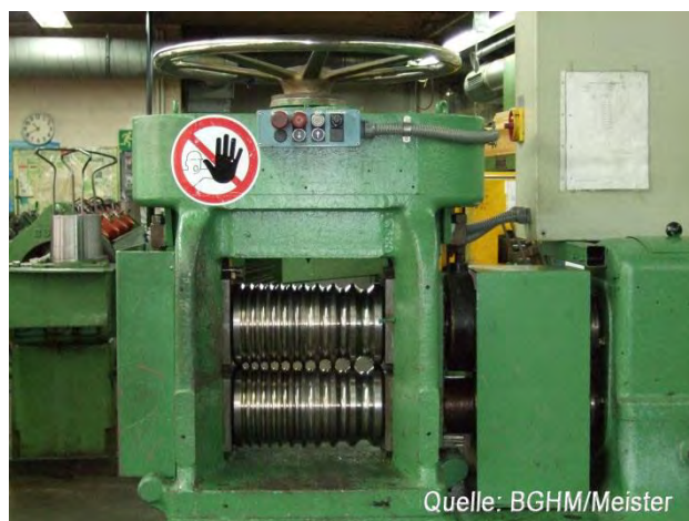
Abb. 10: Tippbetrieb beim Drahtwalzen
