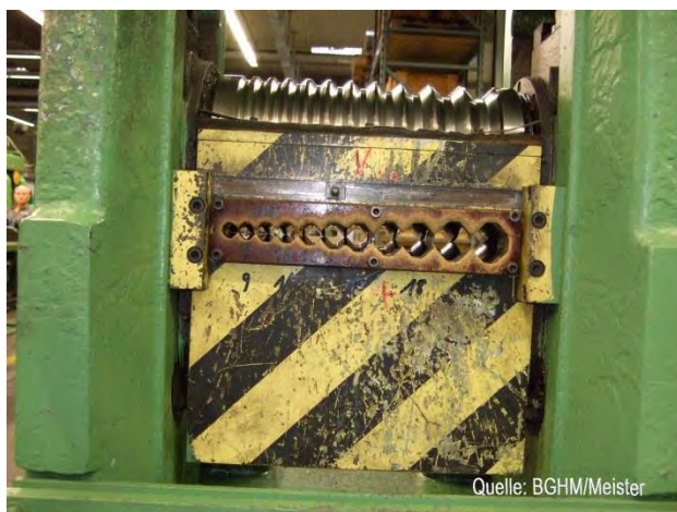
Abb. 4: Fest angebrachte trennende Schutzeinrichtung aus Pertinax an einer Drahtwalze
