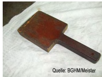
Abb. 5: Schiebegerät für kleine Teile
