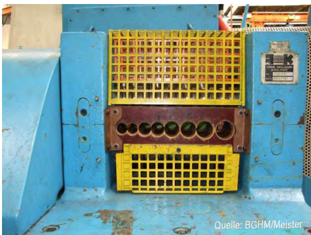
Abb. 1: Fest angebrachte trennende Schutzeinrichtung aus Hartholz an einer Drahtwalze
