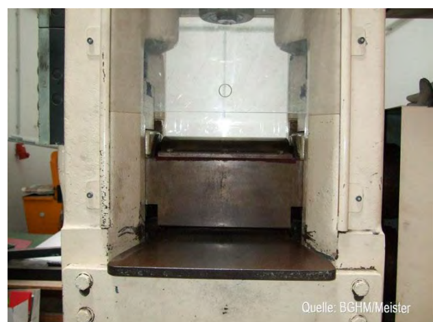
Abb. 7: Feste Verdeckung beim Blechwalzen
