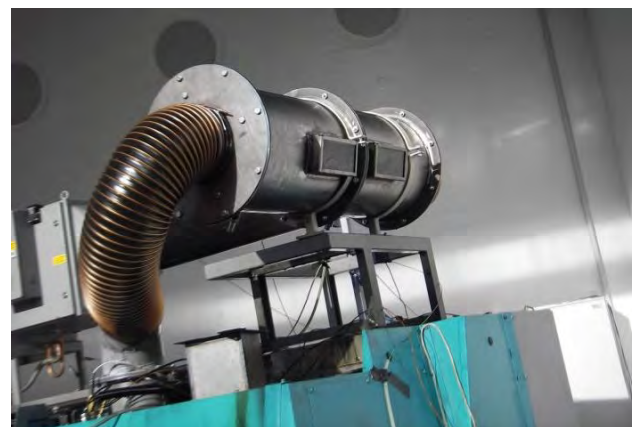
Bild 3: Flammensperre von INDEX/Büchel
