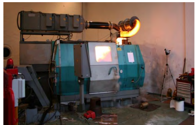
Bild 2: Flammendurchschlag in die Absaugung
