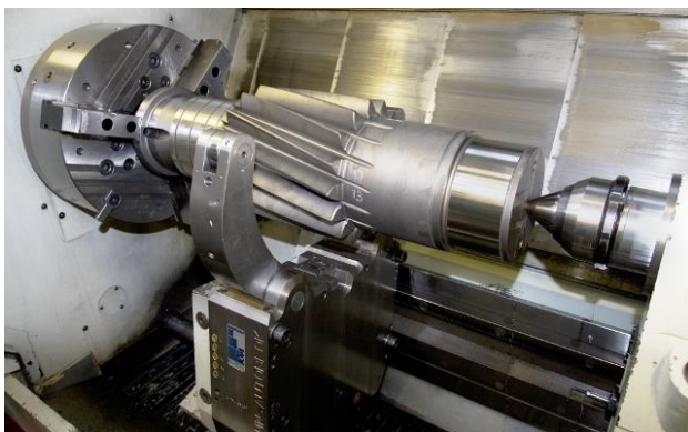
Bild 1: Futter, nicht gespannte Lünette und Pinole auf Reitstock mit 600 kg Werkstück
